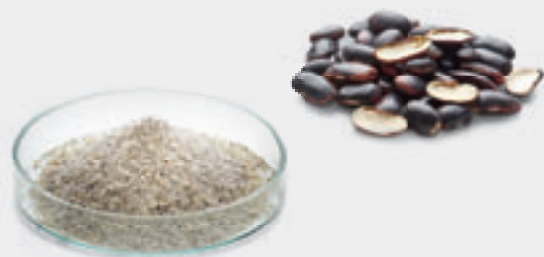
Amostra homogênea: Feijões antes e depois da moagem com o moinho de rotor de velocidade variável PULVERISETTE 14
